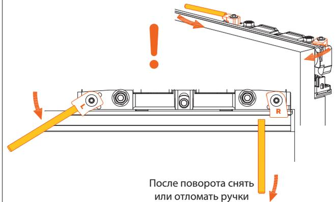
Отрегулировать расстояние от двери до стены и параллельность двери и стены (для компенсации неровностей стены), повернув два болта
