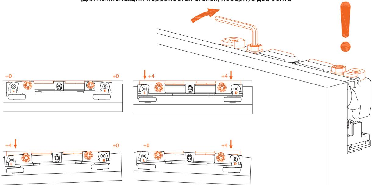
При необходимости - отрегулировать положение механизма мягкого закрывания, двигая дверь относительно ролика
