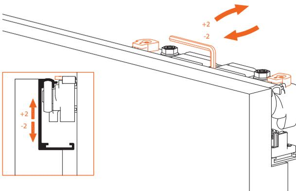
Активировать блокировочную систему защиты от срыва, повернув болты по краям ролика с помощью поворотных ручек, затем снять ручки
